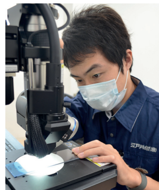
技术开发人员在检查μ单位的油漆膜的光滑度。
